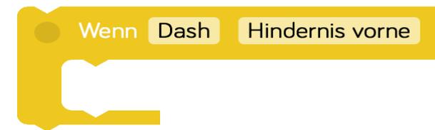
Das eingebettete Programmstück wird **nur dann** ausgeführt, **wenn** die angegebene Bedingung erfüllt ist. Ist die Bedingung nicht erfüllt, wird die eingebettete Sequenz übersprungen.
