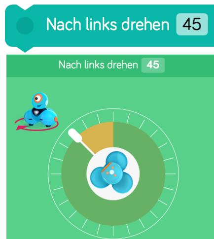
„**Nach links drehen**“- und „**Nach rechts drehen**“-Blöcke verwenden Grad als Einheit. Durch Tippen auf den Block öffnet sich ein Fenster. In Schritten von 15 Grad können Sie Bewegungen von 0 bis 360° einstellen.
